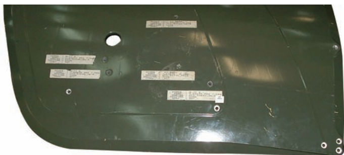
Узорак панцирне плоче обликоване према површини бочних страница шрупа у пределу кабине „јастреба“ који је коришћен за провере заусиљавне моћи карактеристичних зрна пешадијског оружја (А. Рагић)
